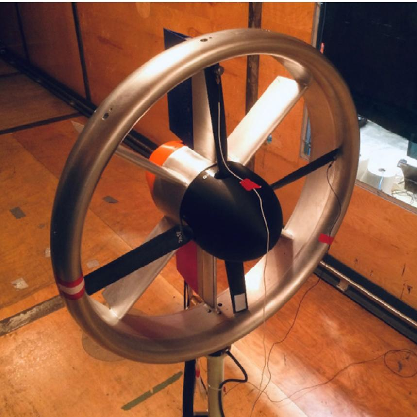
Figure 3 – Prototype d'hélice carénée dans la soufflerie du laboratoire Thermaus de l'Université de Sherbrooke
