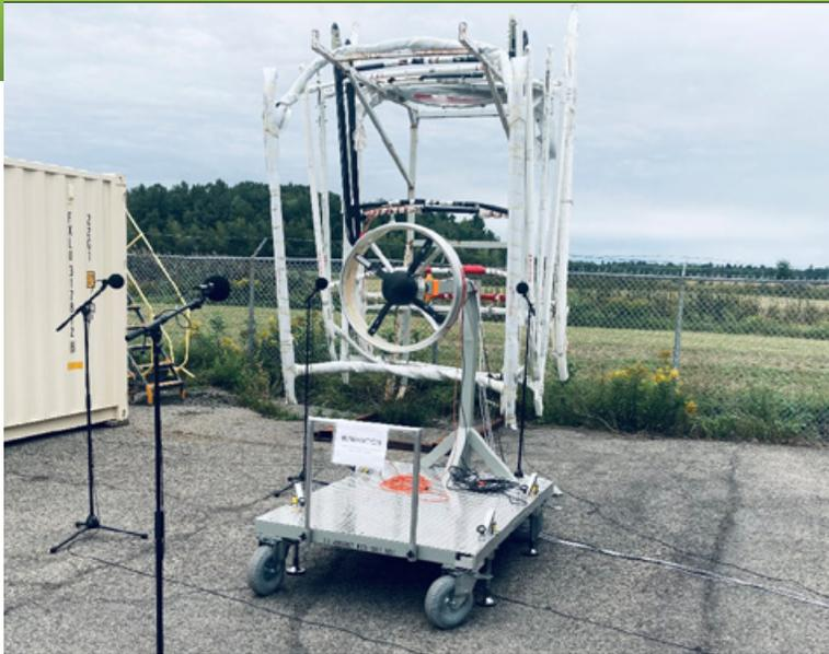
Figure 1 - Banc d'essai mis en place chez Bell pour les mesures de bruit externe d'une hélice carénée
