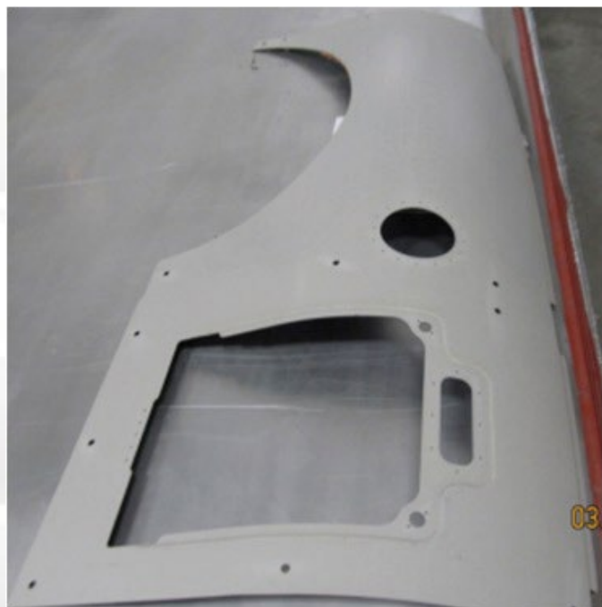
Panneau d'accès typique fabriqué par la méthode de placement automatisé de fibres
