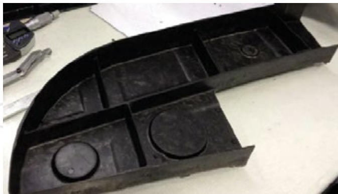
Élément de structure fabriqué par la méthode de moulage par compression
