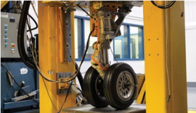
Train d'atterrissage du LearJet 45 instrumenté pour le projet.
