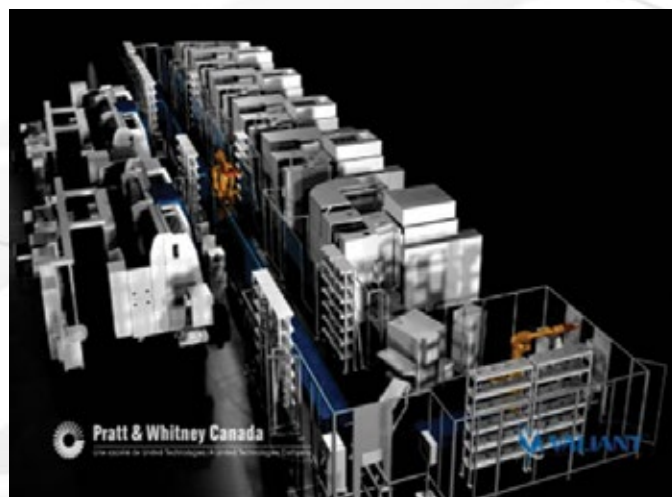
Schéma d'une cellule intelligente de rotor aubagé monobloc en nickel
